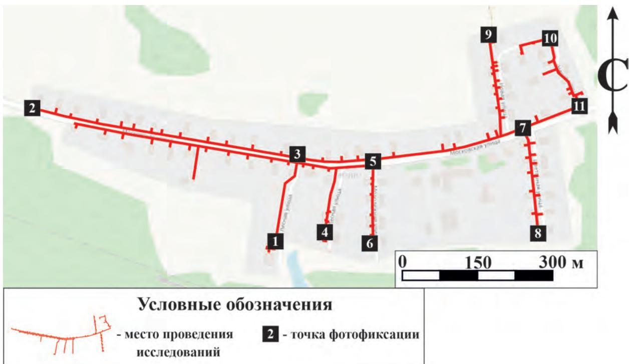
**Рис.7.**Строительство распределительного газопровода в с. Таборы Оричевского района Кировской области. Обследованная территория на общедоступной топографической карте (сервис Nakarte.me) с указанием точек фотофиксации.
