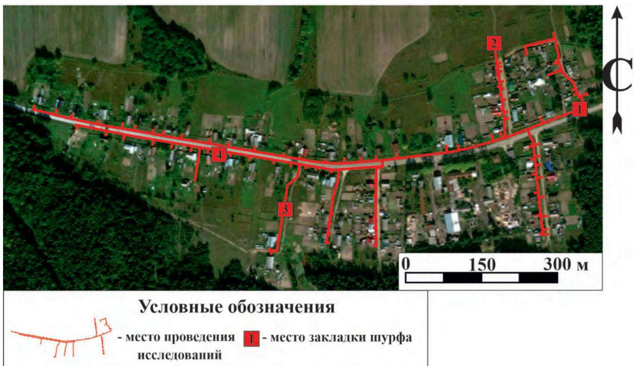
**Рис.10.**Строительство распределительного газопровода в с. Таборы Оричевского района Кировской области. Обследованная территория на спутниковом снимке (сервис Bing) с указанием местоположения разведочных шурфов.
