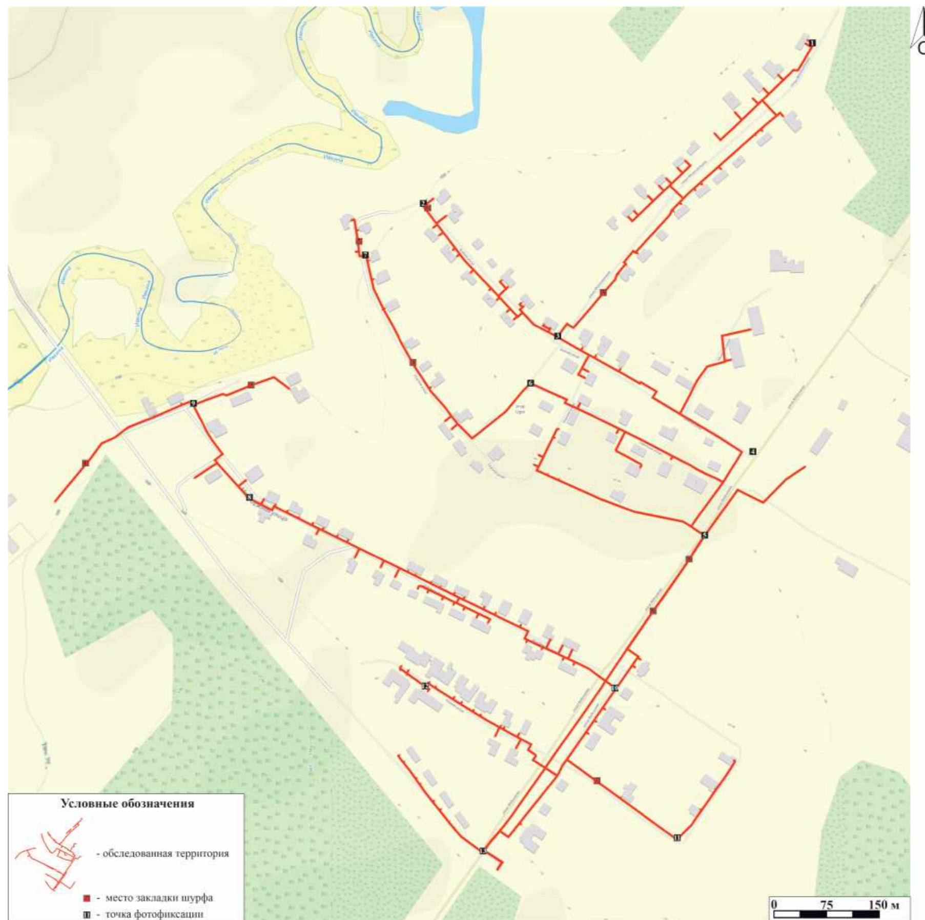
Рис.9. «Строительство распределительного газопровода в д. Угор Верхошижемского района Кировской области» в Верхошижемском районе Кировской области. Обследованная территория на общедоступной топографической карте (сервис Nakarte.me) с указанием точек фотофиксации и местоположения разведочных шурфов.
