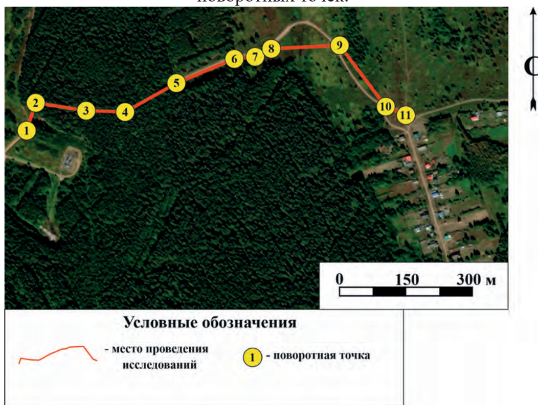
Рис.8. Строительство межпоселкового газопровода к д. Сметанники Кирово-Чепецкого района Кировской области. Обследованная территория на спутниковом снимке (сервис Bing) с указанием поворотных точек. Дата обращения: 10.10.2023 г.
