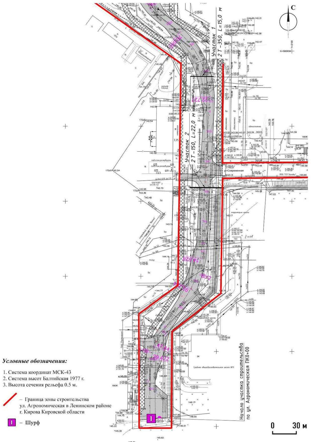
Рис. 11. Фрагмент инженерно-топографического плана с обозначением исследуемой территории и заложенных шурфов в зоне строительства ул. Агрономической в Ленинском районе в г. Кирове Кировской области.
