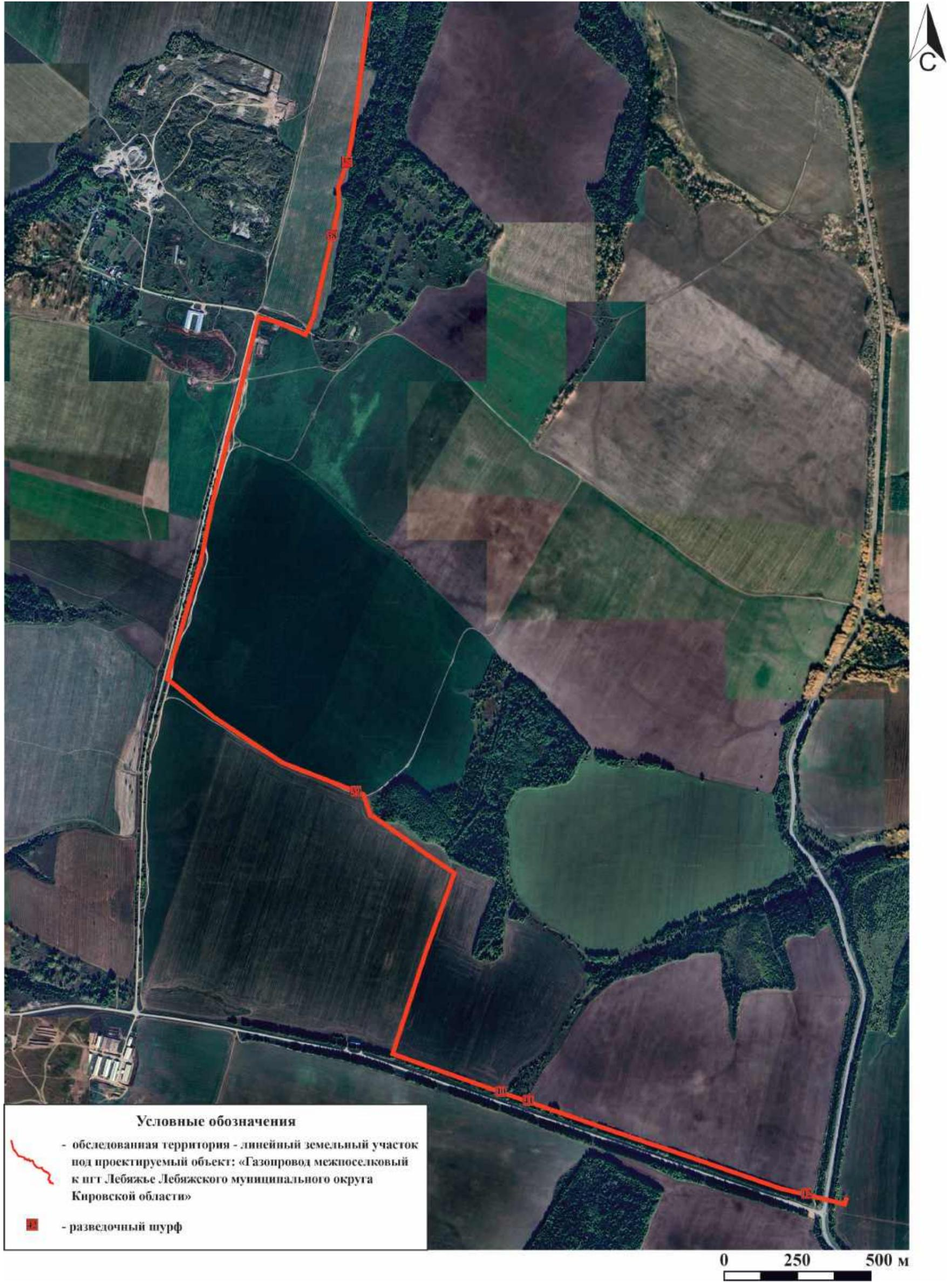
**Рис.40.** "Газопровод межпоселковый к пгт Лебяжье Лебяжского муниципального округа Кировской области". Обследованная территория на спутниковом снимке (сервис Google Планета Земля) с указанием местоположения разведочных шурфов. Дата обращения: 15.05.2024 г. Дата снимка: июль, 2023 г.
