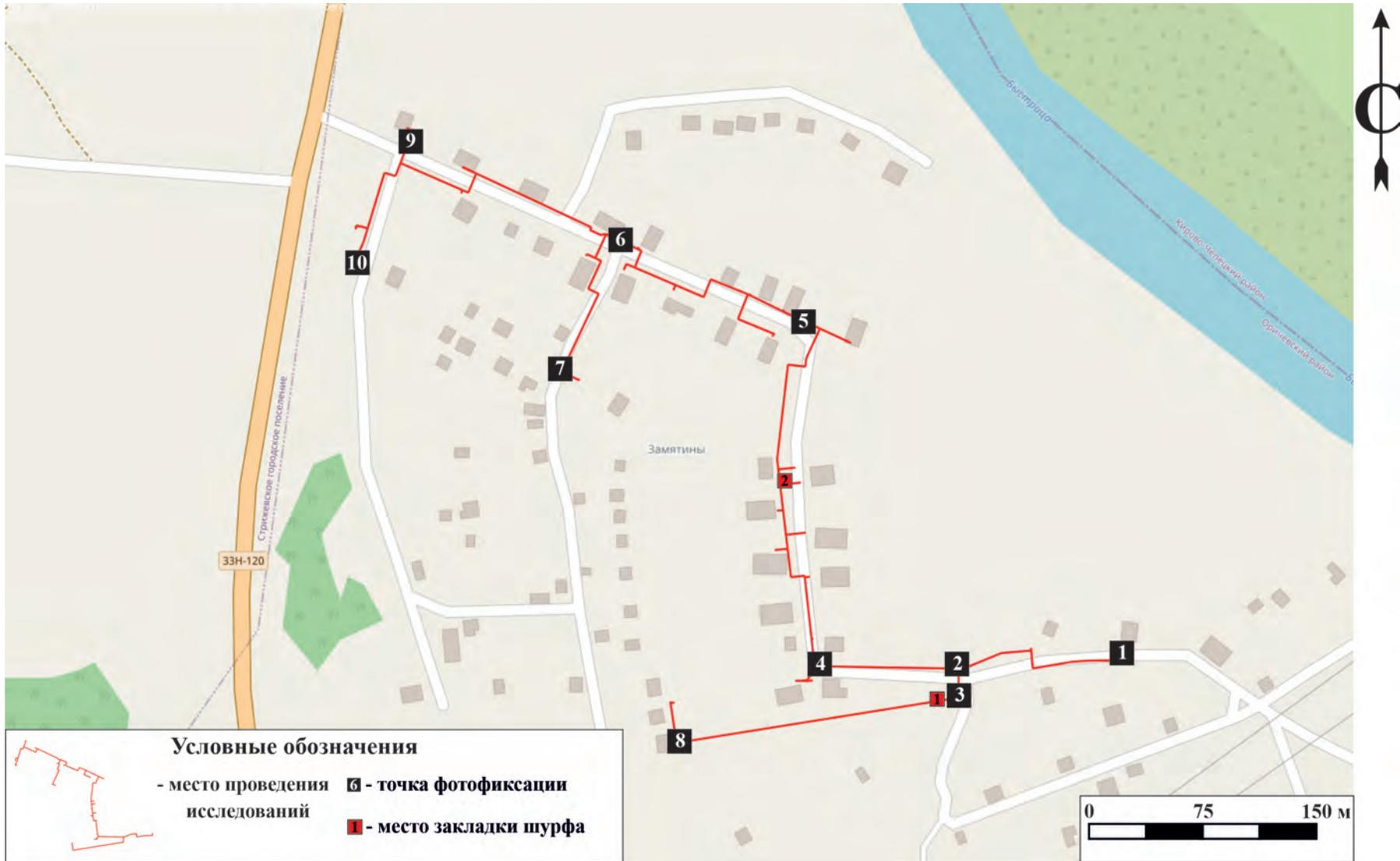
**Рис.7.** Строительство распределительного газопровода в д. Замятины Оричевского района Кировской области. Обследованная территория на общедоступной топографической карте (сервис [Nakarte.me](http://Nakarte.me)) с указанием точек фотофиксации и местоположения разведочных шурфов
