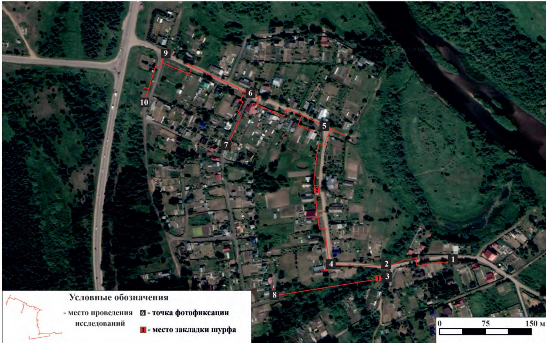
**Рис.8.** Строительство распределительного газопровода в д. Замятины Оричевского района Кировской области. Обследованная территория на общедоступной топографической карте (сервис Nakarte.me) с указанием точек фотофиксации и местоположения разведочных шурфов
