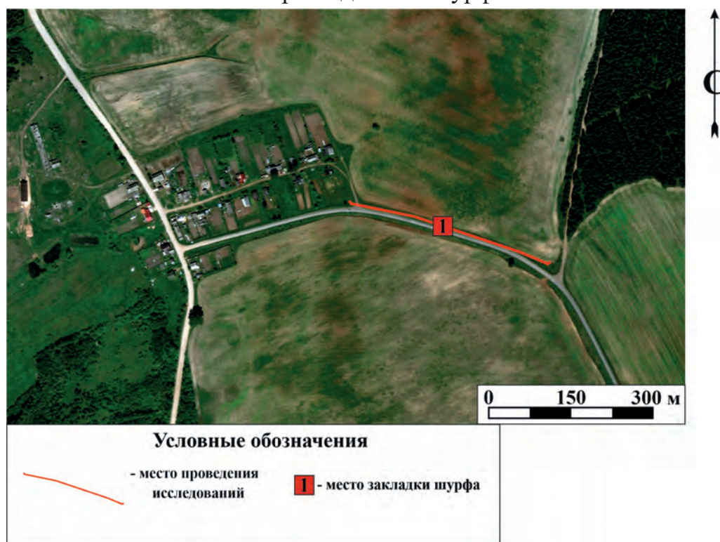
Рис.10. Строительство межпоселкового газопровода к д. Нижние Булдаки Слободского района Кировской области. Обследованная территория на спутниковом снимке (сервис Bing) с указанием местоположения разведочных шурфов. Дата обращения: 10.10.2023 г.
