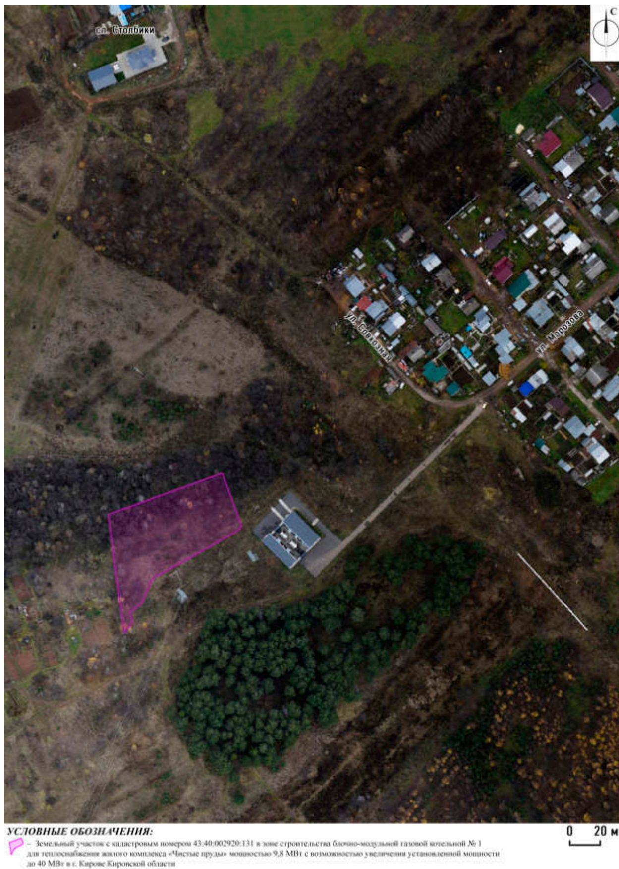
Рис. 8. Фрагмент публичной кадастровой карты с наложением на космический снимок и с обозначением границ земельного участка с кадастровым номером 43:40:002920:131 в зоне строительства блочно-модульной газовой котельной № 1 для теплоснабжения жилого комплекса «Чистые пруды» в г. Кирове Кировской области. Источник: Портал пространственных данных «Национальная система пространственных данных» (сайт: https://nspd.gov.ru/ ).
