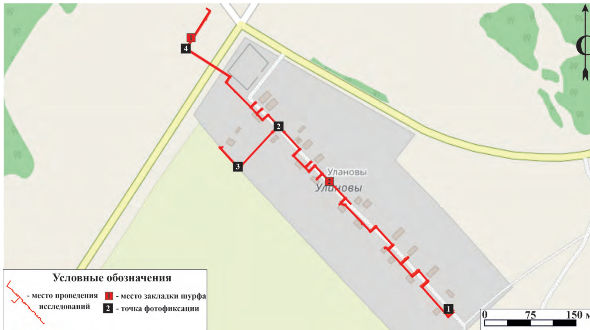
Рис.7. Строительство распределительного газопровода в д. Улановы Оричевского района Кировской области. Обследованная территория на общедоступной топографической карте (сервис Nakarte.me) с указанием точек фотофиксации и местоположения разведочных шурфов.
