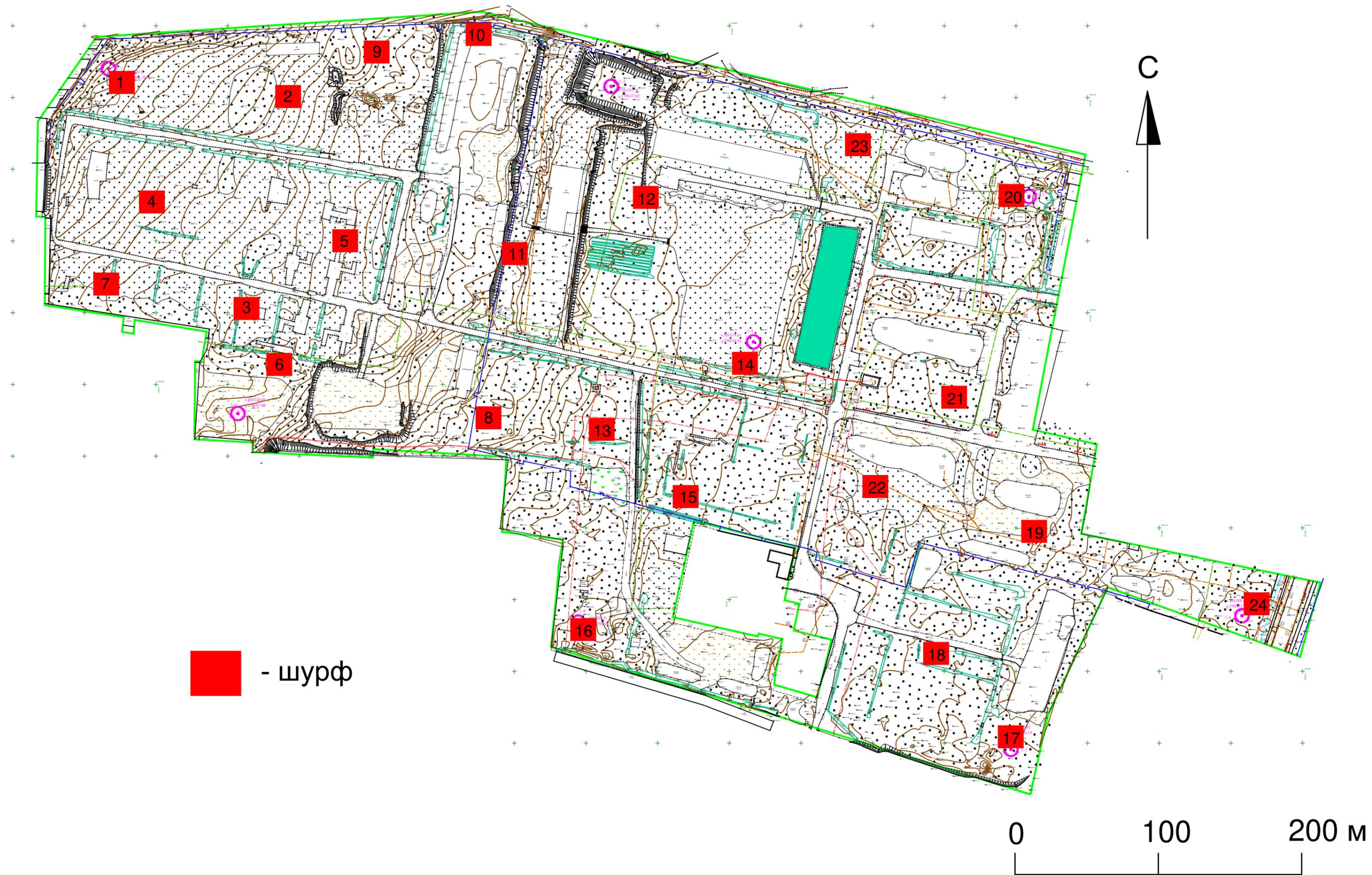
Рис. 6. План-схема планировки земельного участка с кадастровым номером 43:40:000125:242 в г. Кирове с указанием заложённых шурфов в 2022 г.
