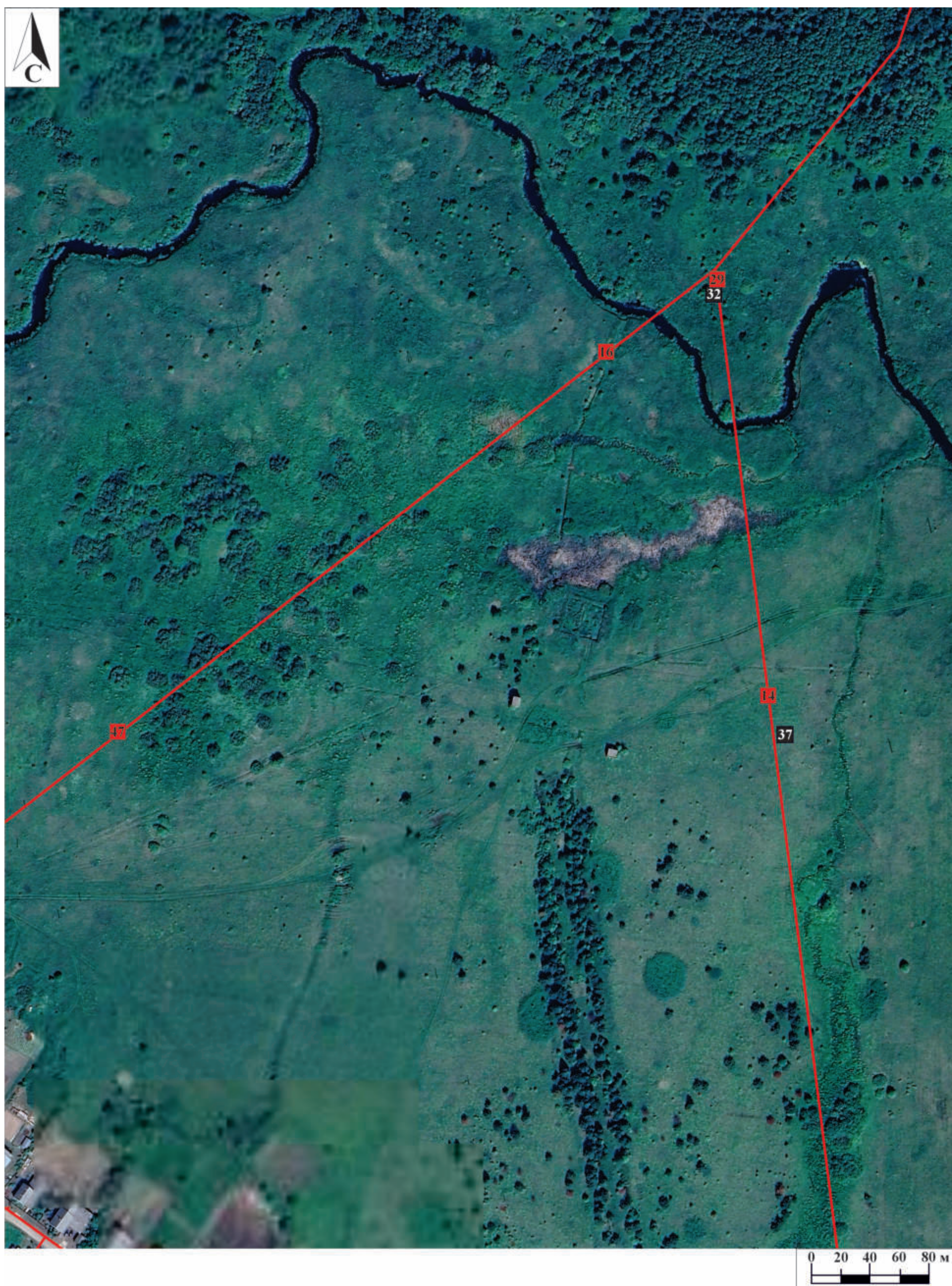
Рис.40. "Газопровод распределительный в пгт Туза Тужинского муниципального района Кировской области" в пгт Туза Тужинского муниципального района Кировской области. Обследованная территория на спутниковом снимке (сервис Google Планета Земля) с указанием точек фотофиксации и местоположения разведочных шурфов (9). Дата обращения: 10.09.2025 г. Дата снимка: июль, 2025 г.
