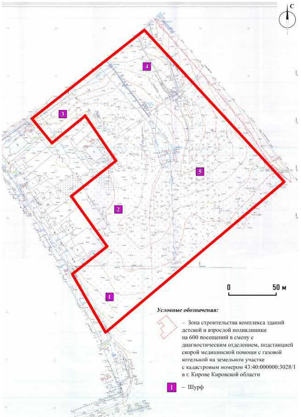
Рис. 9. Инженерно-топографический план с обозначением исследуемой территории и заложённых шурфов на земельном участке с кадастровым номером 43:40:000000:3028/1 в г. Кирове Кировской области.
