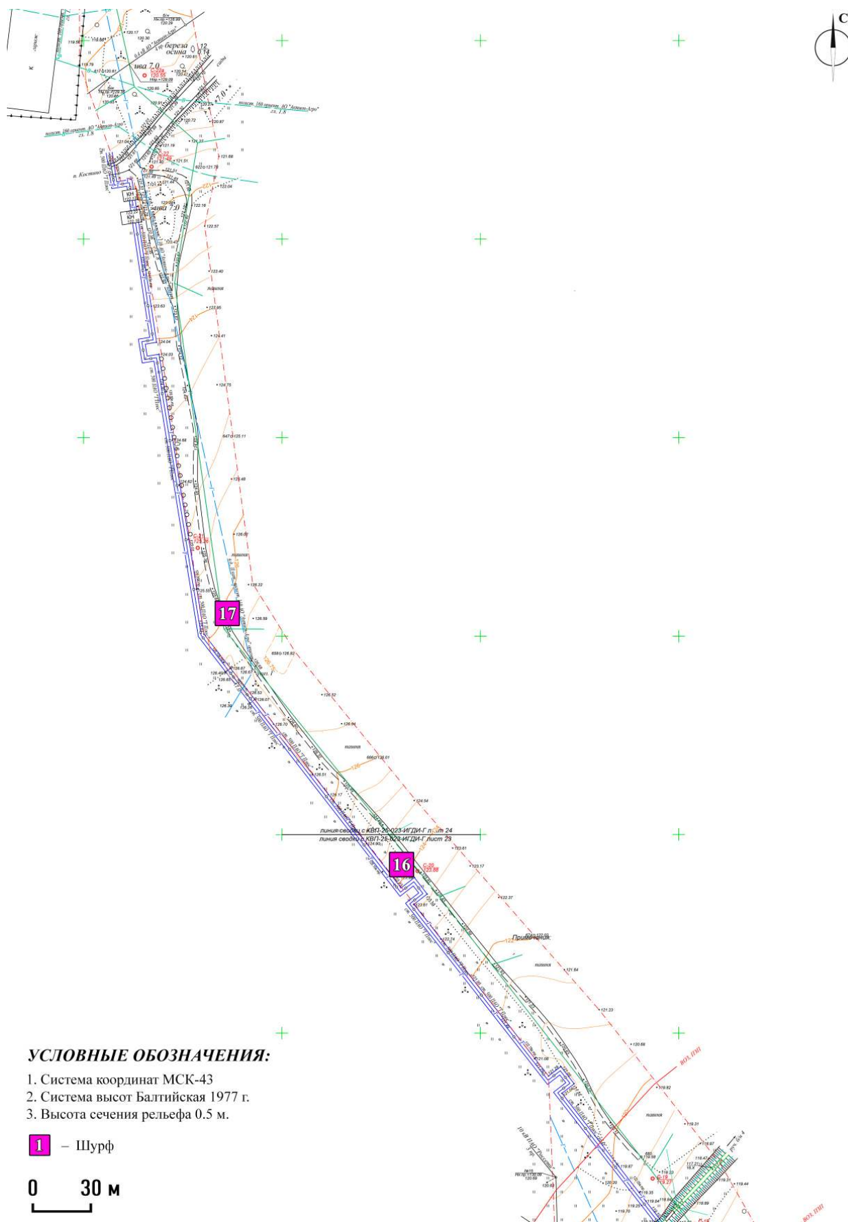
Рис. 32. Фрагмент инженерно-топографического плана с обозначением исследуемой территории и заложенных шурфов на земельных участках в зоне строительства напорного коллектора ОСК Лянгасово – КНС пос. Костино г. Кирова Кировской области.
